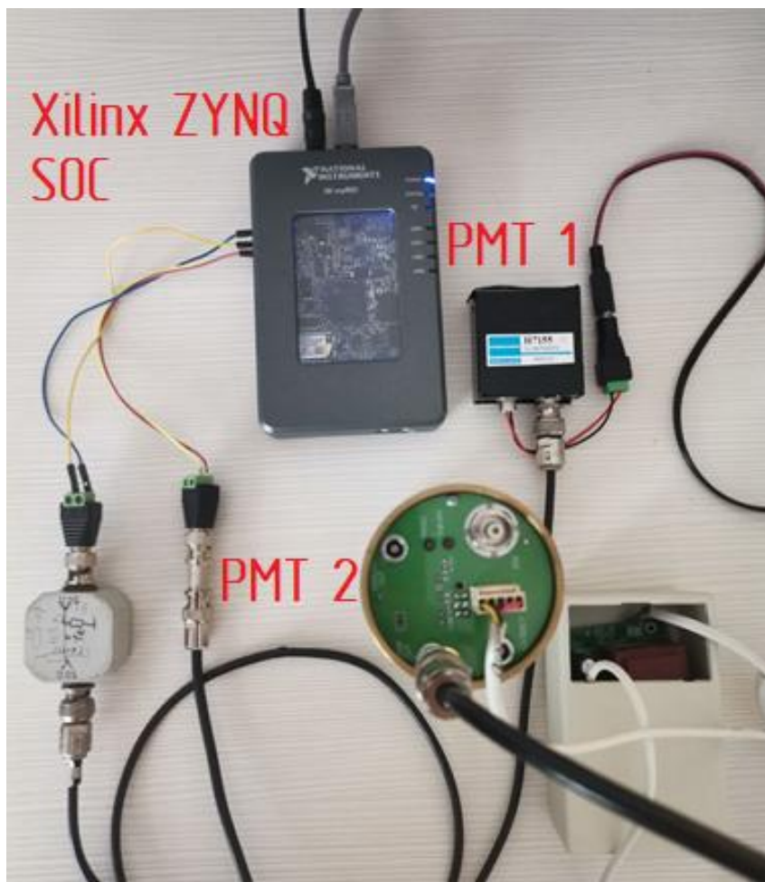
Рис.7. Двухканальная система детектирования одиночных фотонов с блоком сбора данных на основе ПЛИС Xilinx ZYNQ
