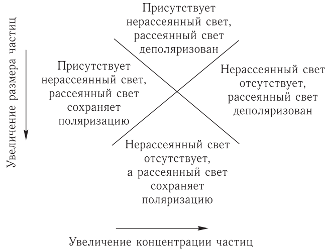
Рис. 2.15. Схематическое представление областей существования режимов поляризации рассеянного света при облучении рассеивающей среды линейно поляризованным излучением
