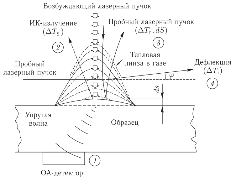
Рис. 7.1. Схематическое представление некоторых методов лазерной калориметрии при исследовании биологических тканей [1276]: \Delta T_s — изменение температуры образца; \Delta T_r — изменение температуры окружающего образец газа; dS — термоупругая деформация; \varphi — угол дефлекции пробного лазерного пучка; 1 — ОА-метод; 2 — ОТР-метод; 3 — метод тепловой линзы; 4 — дефлекционный метод
