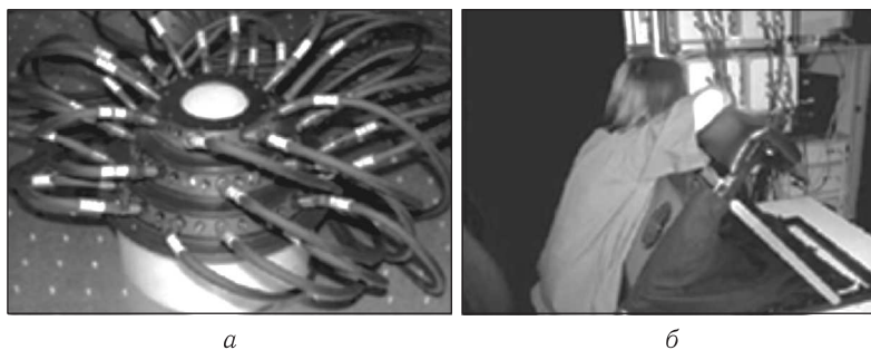
Рис. 2.10. Типичная многоканальная оптическая импульсная томографическая система: a — волоконно-оптическая система, обеспечивающая передачу оптических сигналов источник–детектор, организованная в виде трех взаимосвязанных кольцевых рамок с посадочными местами для волокон; кольцевые рамки обеспечивают оптический контакт торцов световодов с поверхностью молочной железы пациента; б — аппаратура и положение пациентки в момент исследования [592]
