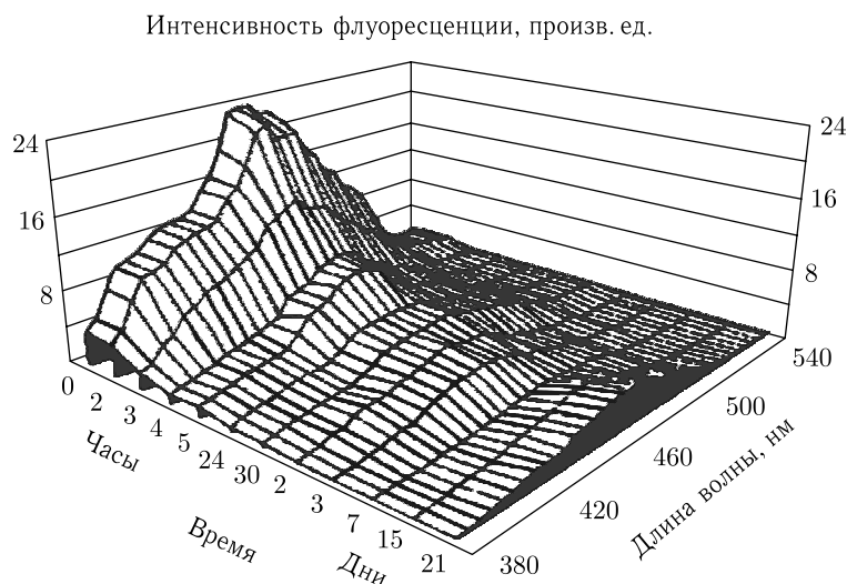
Рис. 5.6. 3D-график автофлуоресценции кожи человека после УФ-облучения, соответствующего четырем минимальным эритемным дозам (МЭД) [1059, 1068]
