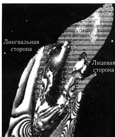
Рис. 12.15. Фазовое изображение, полученное из четырех отдельных сдвинутых по фазе изображений в модели пролеченного зуба при нагрузке 125 Н под углом 60^\circ к длинной оси зуба в направлении к языку [1942]
