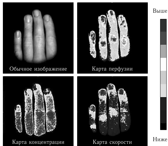
Рис. 13.15. Карты параметров кровотока, полученные с помощью CMOS интегрированного визуализатора на коже пальцев (участок размером 512 \times 512 пикселей): изображение объекта (изображение интенсивности); карта перфузии (наименьшая перфузия равна 200 о.е., наибольшая — 700 о.е.); карта распределения концентрации крови (наименьшая концентрация равна 140 о.е., наибольшая — 310 о.е.); карта скорости потока (наименьшая скорость потока равна 400 о.е., наибольшая — 1500 о.е.). Отображаемая область 11 \times 11 \text{ см}^2 . Полное время получения изображения 5 с; о.е. — относительные единицы [1978]
