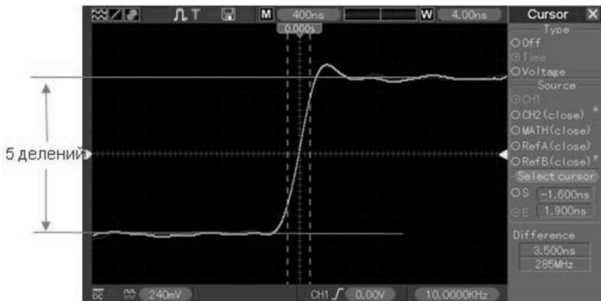
Рис. 2.9. Измерение времени нарастания импульса
