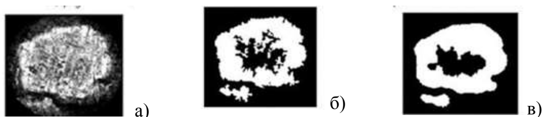
Рис.2. Бинарное изображение признака в виде пятна неопределенной формы: а) - исходное изображение следа бойка; б) - бинарное изображение следа бойка; в) – бинарное изображение после применения сглаживающей фильтрации.
