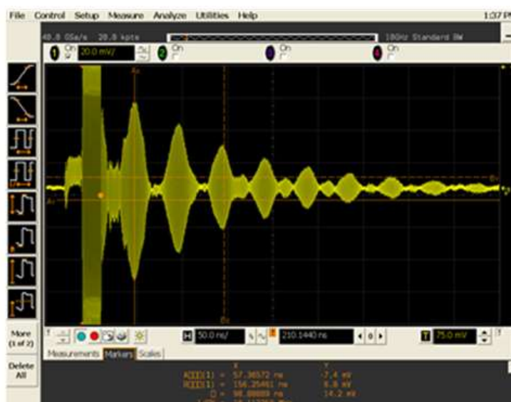
Рис.2. Осциллограмма отраженных эхоимпульсов ОСВ
