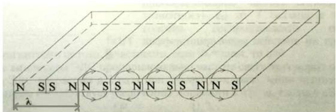
Рисунок 2. 3 - Сигналограмма при продольном намагничивании гармоническим сигналом.
