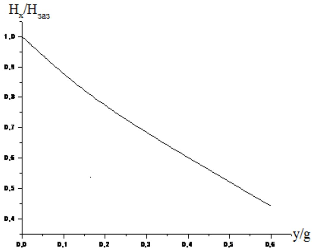
Рисунок 3.6 – Распределение магнитного поля по толщине носителя при  $x=0$ .
