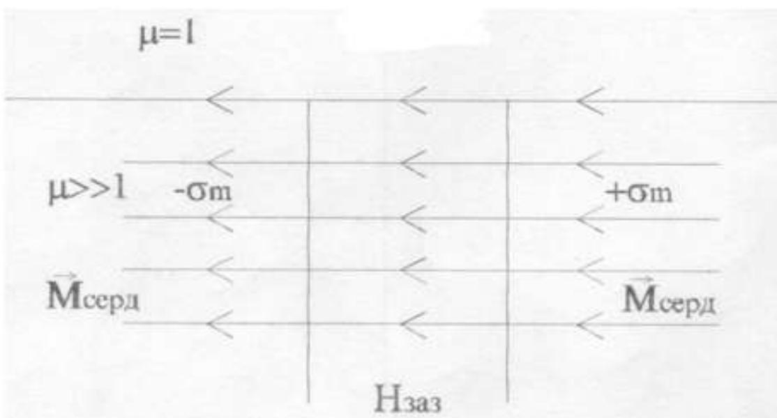
Рисунок 3.3 - Магнитное поле в зазоре головке.
