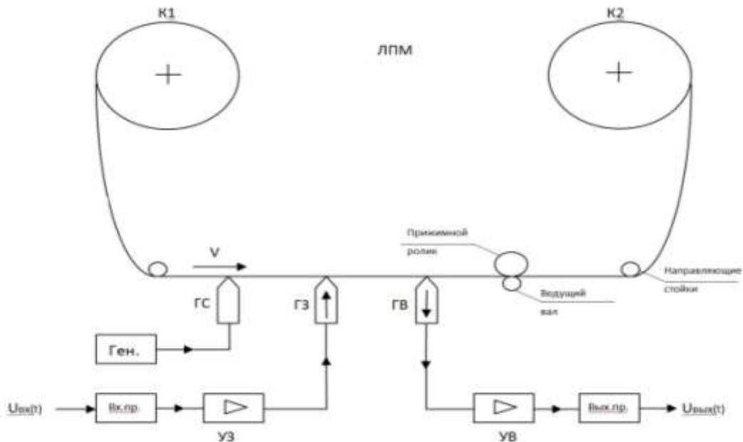
Рисунок 2.1- Структурная схема канала записи-воспроизведения.
