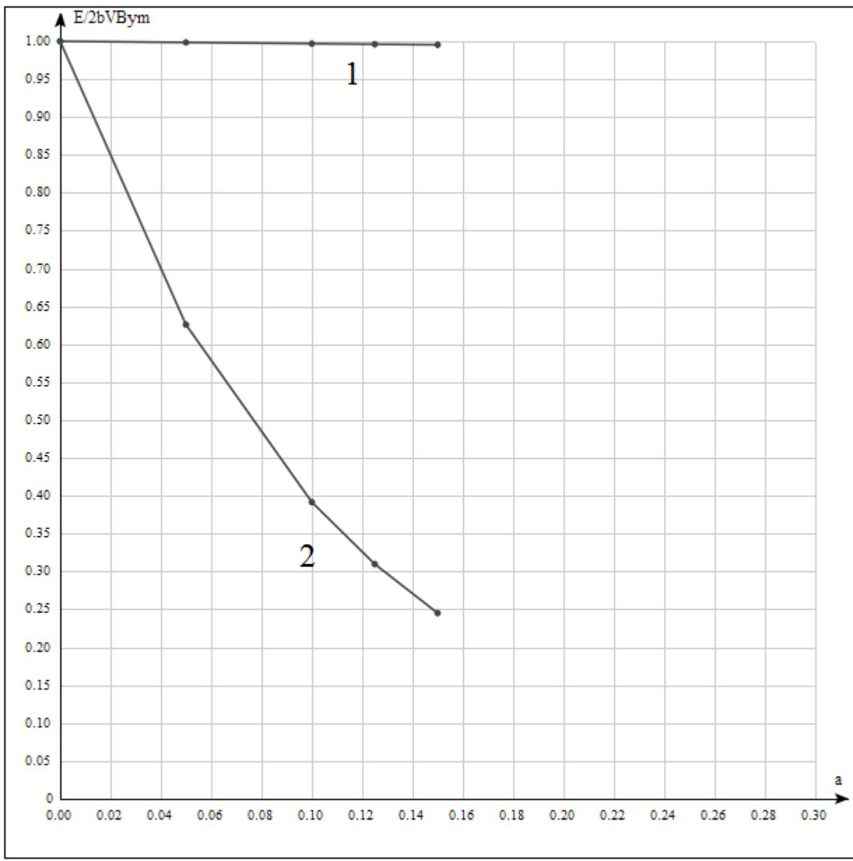
Рисунок 9.1 - Зависимость ЭДС воспроизведения  $\varepsilon$  от неконтакта между головкой воспроизведения и носителем информации при различных значениях волны записи  $\lambda$ :
