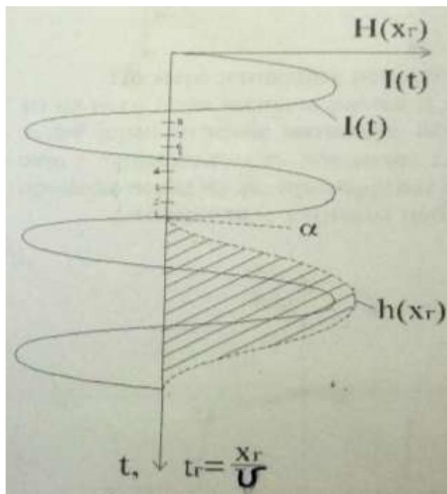
Рисунок 4.2.1 Кривые для нахождения остаточной намагниченности действующего на носитель поля в случае записи без подмагничивания быстроизменяющихся синусоидальных сигналов. 1, 2, ..., 8 – элементы носителя
