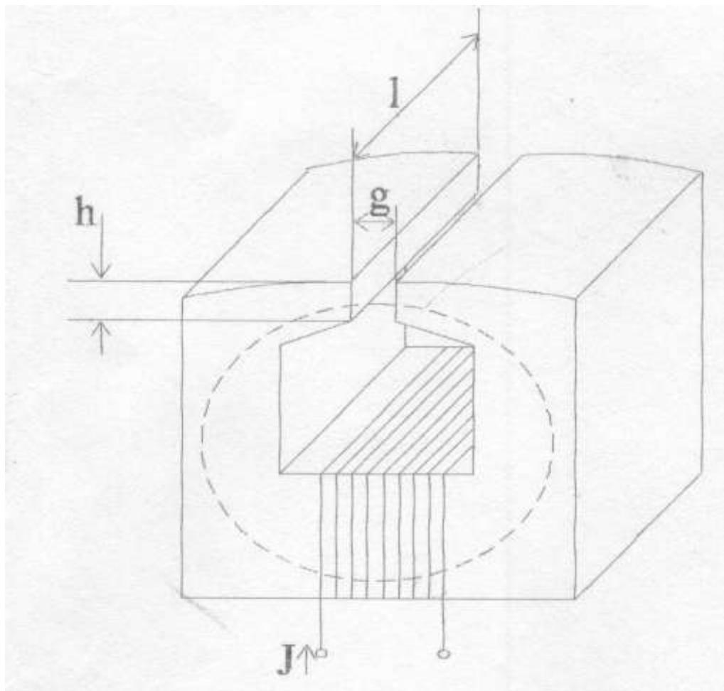
Рисунок 3.1- Кольцевая магнитная головка.
