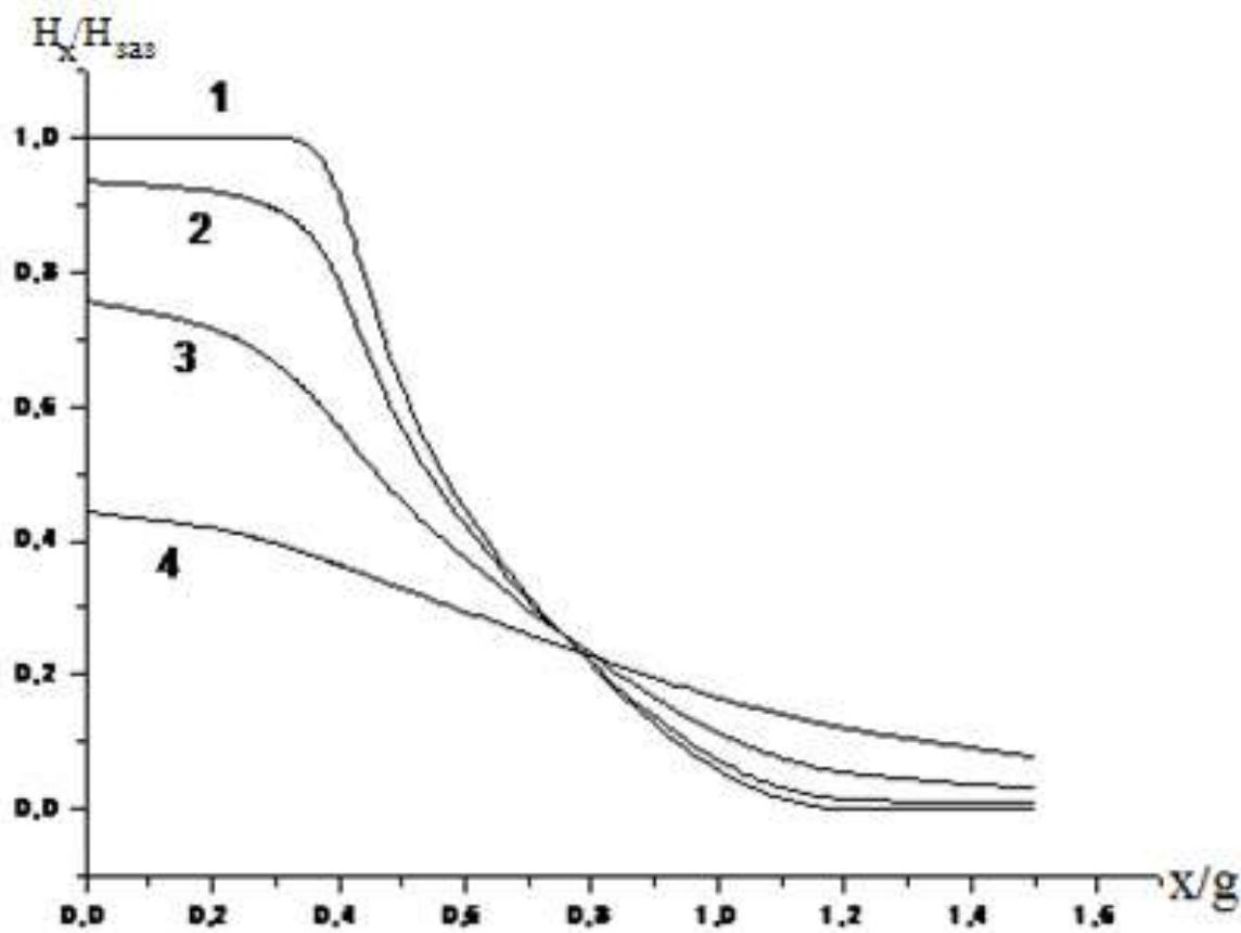
Рисунок 3.5 – Распределение составляющей магнитного поля головки  $H_x$ , нормированной к  $H_{заз}$ , вдоль координаты  $x$  носителя.
