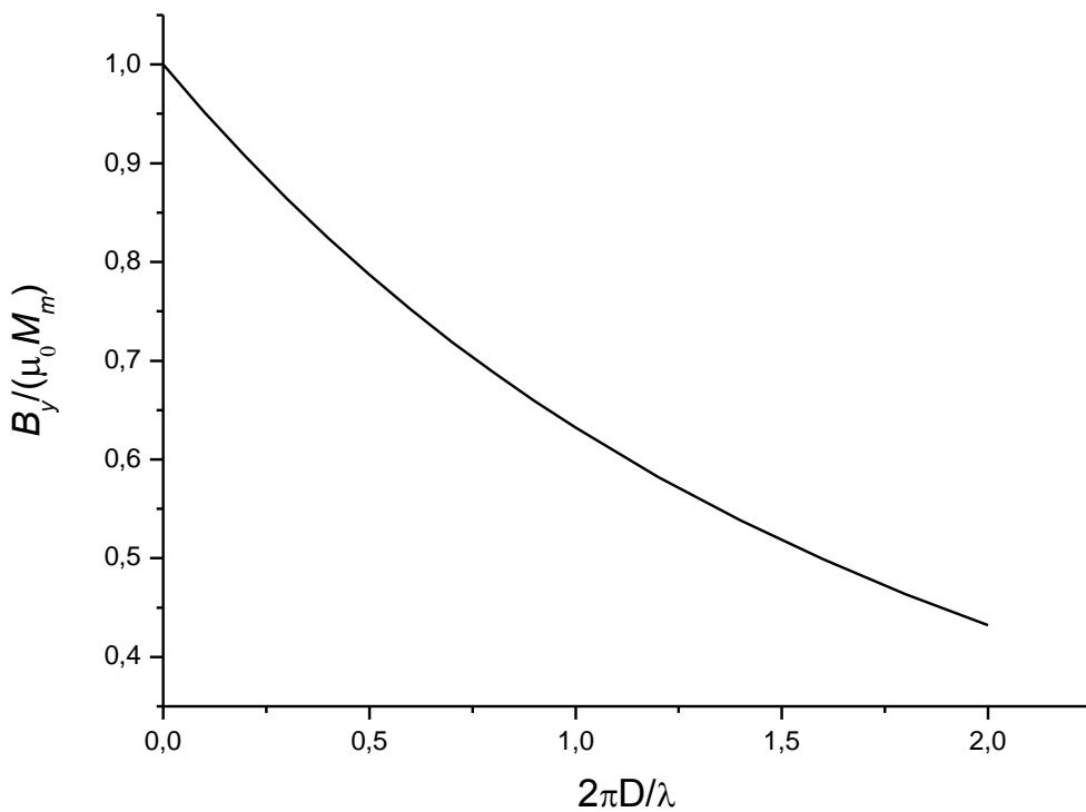
Рисунок 7.2 - Зависимость поверхностной магнитной индукции от толщины носителя.
