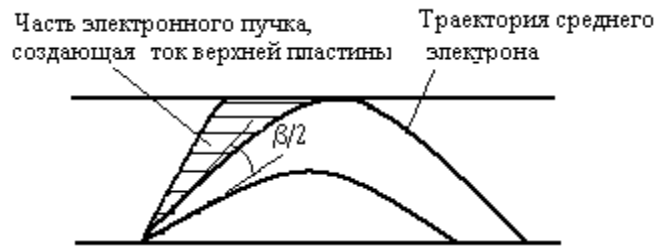
Рис.7. Схематическое изображение электронного пучка, создающего ток верхней пластины конденсатора
