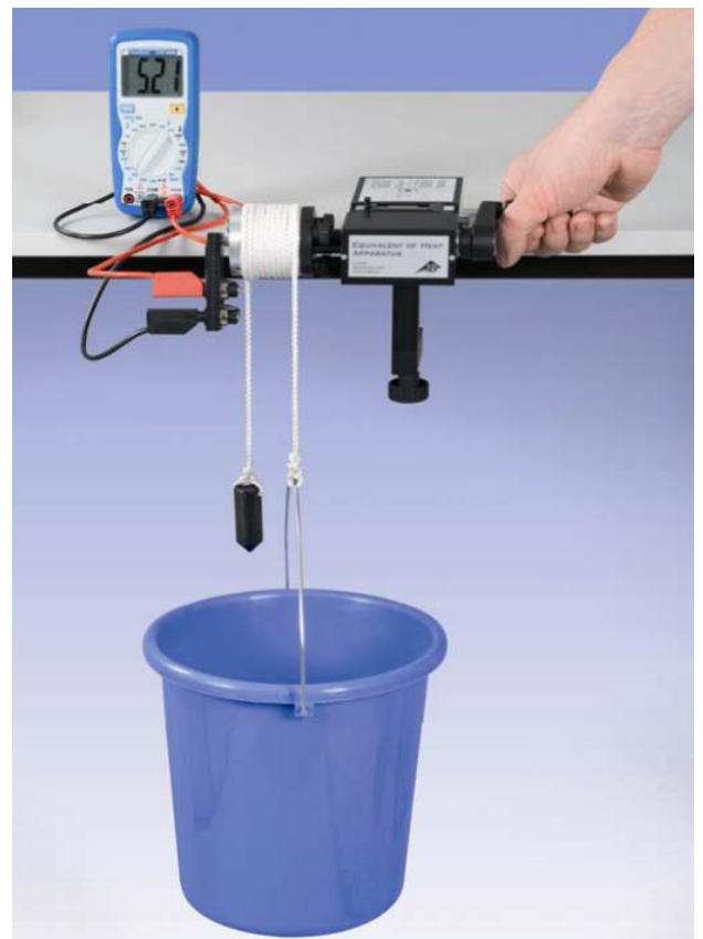
Рис. 1. Экспериментальная установка для демонстрации первого закона термодинамики
