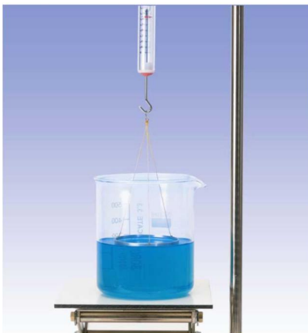
Рис. 3. Лабораторная установка для измерения поверхностного натяжения
