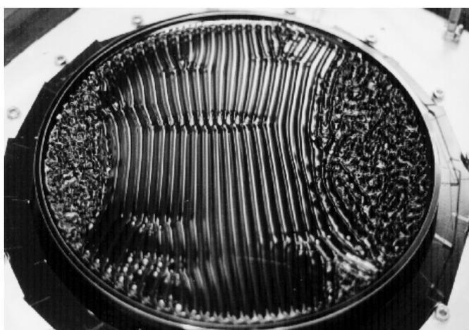
Рис. 5: Структура поверхности жидкости для режима перемежаемости. (из [7]) Видно, что амплитуда волн в области с хаотической динамикой, существенно больше, чем в области регулярных структур
