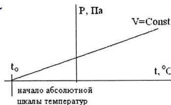
В ходе эксперимента определите температурный коэффициент давления  $\alpha$  и положение нуля абсолютной шкалы температур.
