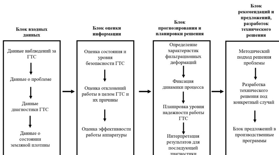
Рисунок 1 - Блок-схема работы системы диагностического контроля фильтрационных утечек через плотину водоема-охладителя Ростовской АЭС
