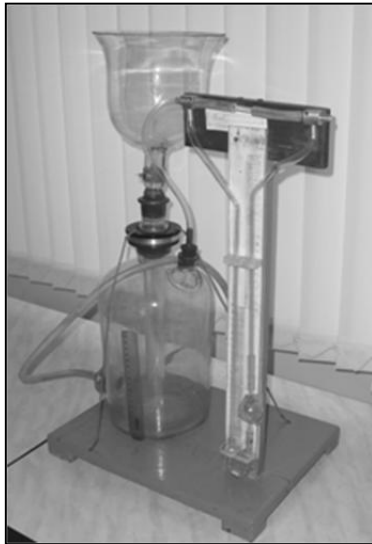
Рис. 4. Газометр: a – внешний вид; б – схема
