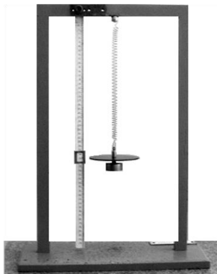
Рис. 5. Пружинный маятник с грузиком, оказывающим заметное сопротивление движению, для исследования затухающих колебаний
