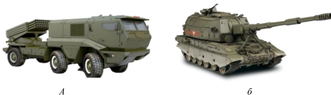
Рис. 2. Основные направления развития артиллерии: а – БМ «Циклон» с блоком ТПК122-мм; б – 2С35 «Коалиция-СВ»
