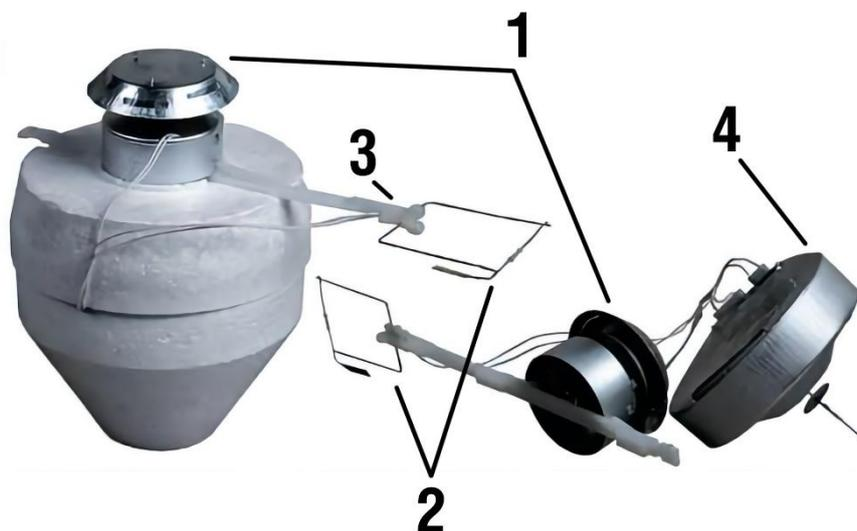
Рисунок 6 – малогабаритный радиозонд МРЗ-3А
