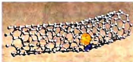
Рис. 2.7. Иллюстрация простейшего дефекта одностенной углеродной нанотрубки – пары пентагональный-гептагональный фрагмент, связывающей участки трубки с различной хиральностью
