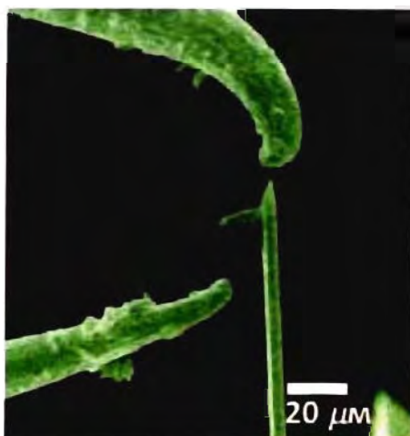
Рис.6.72. Наноскальпель на основе одностенной углеродной нанотрубки
