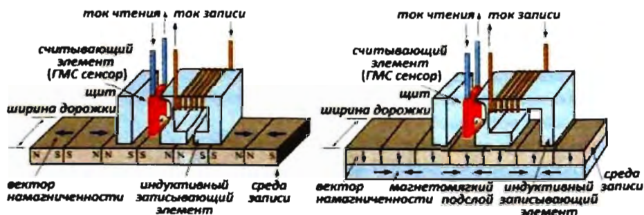
Рис. 6.50. Схема реализации продольной (а) и перпендикулярной (б) записи
