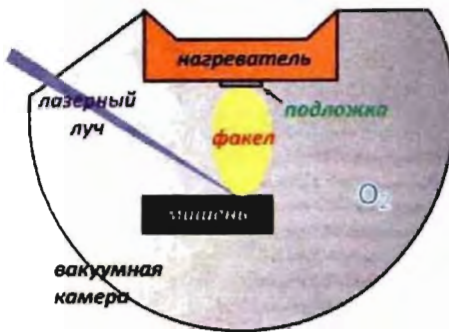
Рис. 2.34. Схема установки для получения пленок импульсным лазерным осаждением
