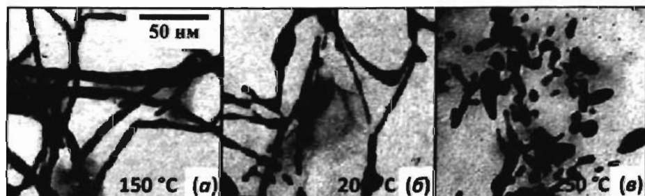
Рис. 4.57. Плавление нитевидных кристаллов Pd, синтезированных в порах мезопористого SiO 2
