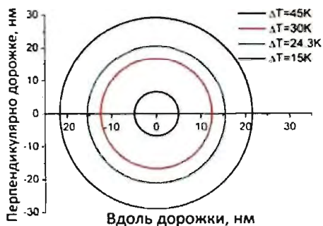
Рис. 6.55. Температурные градиенты на пленке магнетика, создаваемые фокусированным лазерным пучком диаметром 25 нм
