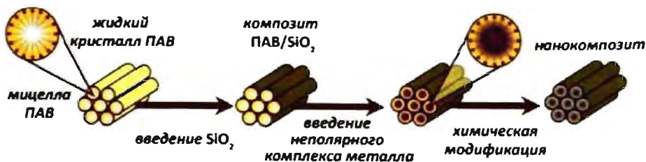
Рис. 4.55. Схема синтеза одномерных наночастиц железа в матрице мезопористого SiO_2
