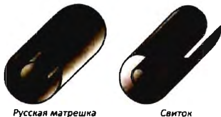
Рис. 2.8. Модели структуры многостенных углеродных нанотрубок: “русская матрешка” (модель вложенных цилиндров) и “свиток”
