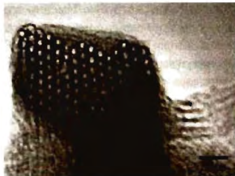
Рис. 2.16. Пучки одностенных нанотрубок, полученные методом лазерного распыления
