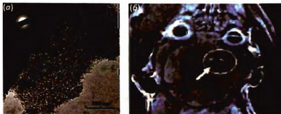
Рис. 6.63. Микрофотография магнитных наночастиц магнетита, полученных осаждением золя из водной фазы (а), магнито-резонансная томография наночастиц в мозговой ткани мыши (б)
