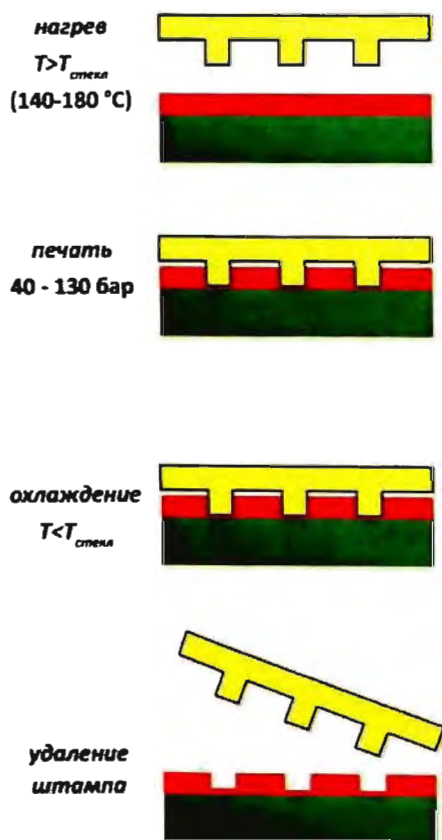
Рис. 4.86. Печатная нанолитография. Метод горячего тиснения
