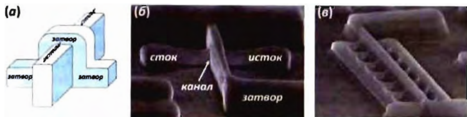
Рис. 6.21. Принципиальная схема (а) и микрофотографии одноканального (б) и многоканального (в) транзистора с трехсторонним затвором (Tri-gate transistor)
