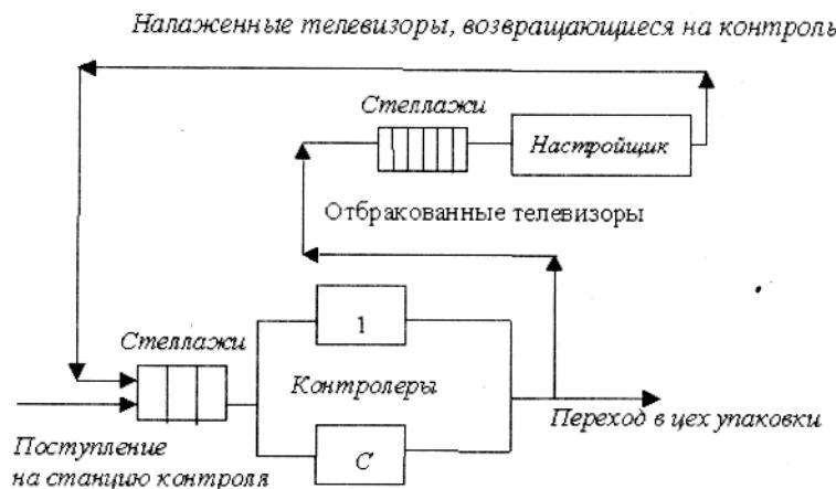
Телевизоры попадают на станцию технического контроля каждые  $A \pm B$  минут. На станции работают  $C$  контролеров одинаковой квалификации. Операция контроля одного телевизора состоит из двух проверок:
