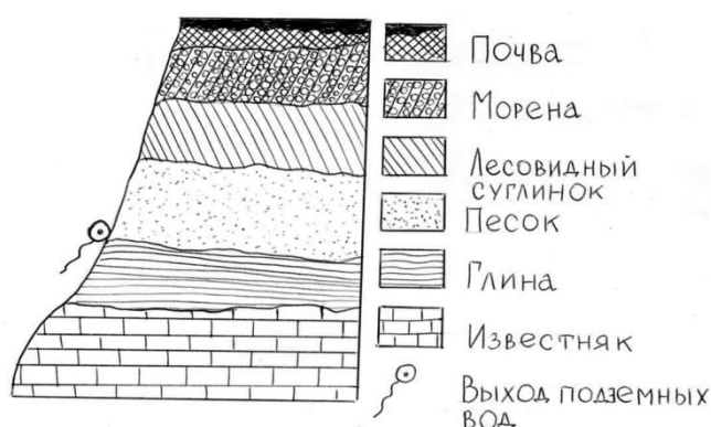
Рис. 3. Схема обнажения горных пород
