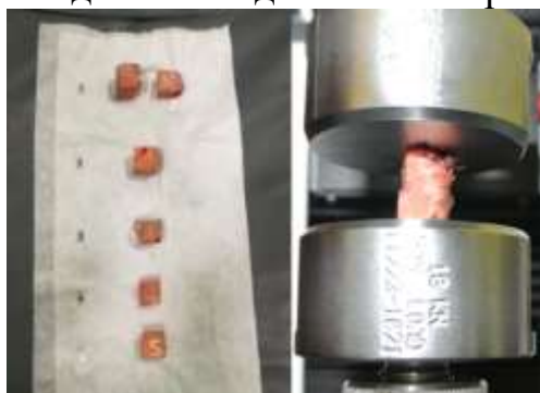
Рисунок 10 – Образцы костных тканей головок бедра: при выполнении КТ и при выполнении эксперимента на сжатие
