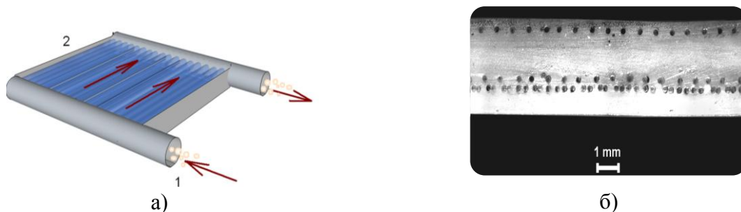
Рисунок 1. Фантом: а) схематичное изображение: 1- суспензия частиц ( d \sim 7-9 \mu\text{m} ); 2- фантом (общее число каналов \sim 300 , d \sim 180-200 \mu\text{m} ); б) изображение фантома в срезе.
