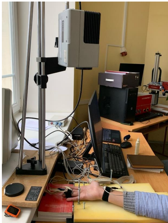
Рисунок 40. Схема эксперимента с одновременной регистрацией реографического объема и объемного кровотока кисти.
