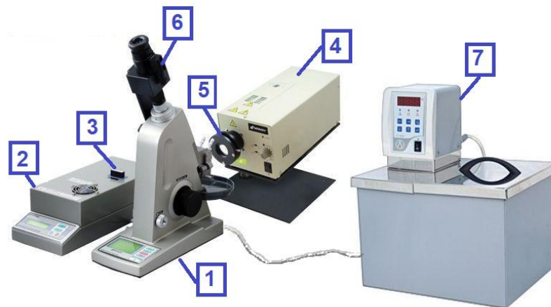
Рисунок 2.1 - Экспериментальная установка для измерения действительной части показателя преломления: 1 - многоволновой рефрактометр Аббе DR-M2 1550 (Атаго, Япония) 2 – блок питания; 3 – рамка интерференционного фильтра; 4 – источник света WL-3 (Атаго, Япония); 5 – интерференционный фильтр; 6 – визуализатор для измерений в БИК области; 7 – циркуляционный термостат LOIP LT 100 (ООО «ЛОИП», Санкт-Петербург, Россия)
