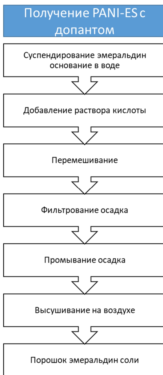
Рисунок 2.9 – Общий вид методики допирования PANI-EB
