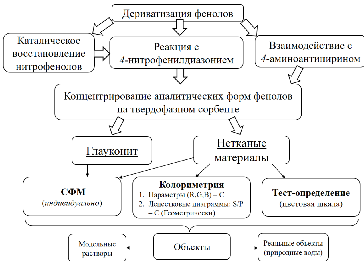
Рисунок 5.3 – Схема сорбционно-фотометрического и цветометрического определения фенолов.
