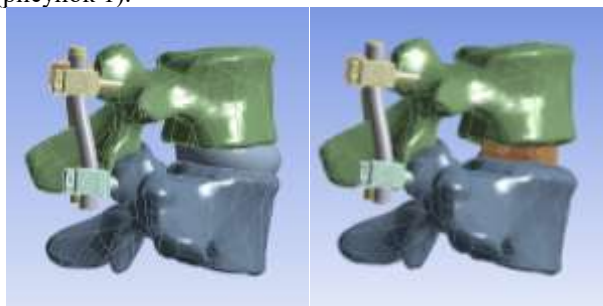
Рисунок 1 – Трехмерные модели сегмента позвоночника с установленными имплантатами
