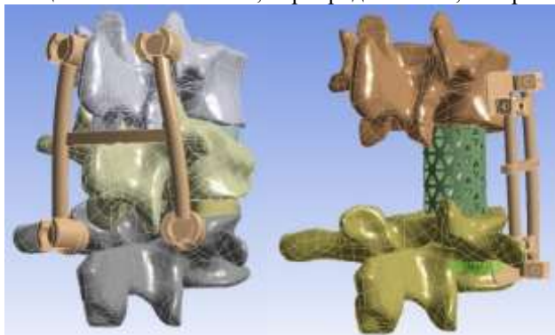
Рисунок 1 – Трехмерные модели сегмента позвоночника с установленными имплантатами
