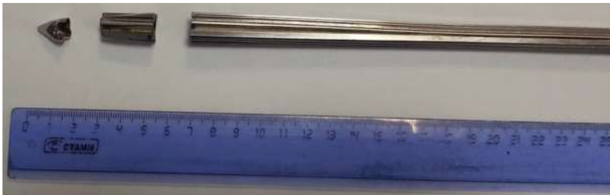
Рисунок 6.26 – Распиленный стержень Fixion. Линейка представлена на рисунке для понимания размеров стержня
