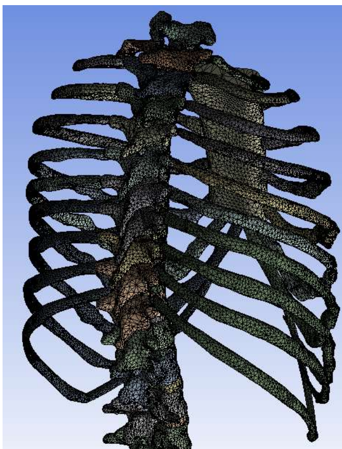
Рисунок 4.12 – Фрагмент вычислительной сетки для модели при наклоне вперед на 5 градусов
