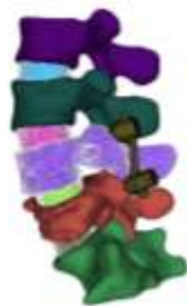
Рисунок 5.20 – Вычислительная сетка, созданная в «Сеточном модуле» для варианта 2 (2 полиаксиальных транспедикулярных винта и 2 редуцированных винта)
