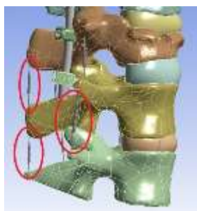
Рисунок 2 – Одномерные модели связок
