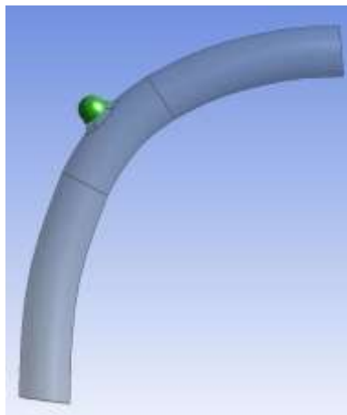
Рисунок 7.25 – Зеленым цветом показан купол аневризмы (на примере модели с AR=0.7 ). В этой области оценивали средние значения касательных напряжений WSS
