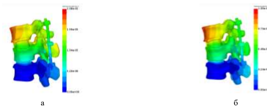
Рисунок 5.10 – Поля полных перемещений для двух вариантов: а – вариант 1 (4 моноаксиальных транспедикулярных винта), б – вариант 2 (6 моноаксиальных транспедикулярных винтов)
