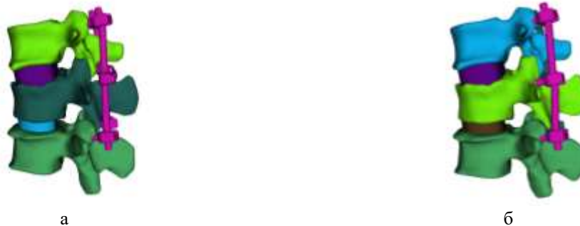
Рисунок 5.8 – Изображения трехмерных моделей сегмента ПТК вместе с установленными имплантатами: а – вариант 1 (4 моноаксиальных транспедикулярных винта), б – вариант 2 (6 моноаксиальных транспедикулярных винтов)
