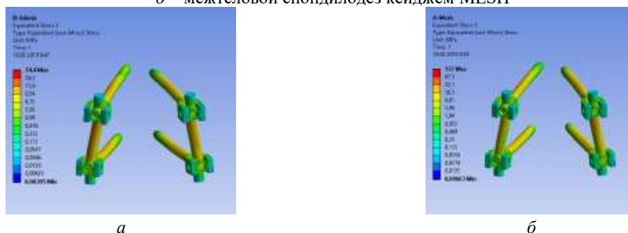
Рисунок 4 –Поля напряжений для двух моделей при наклоне: а – межтеловой спондилодез кейджем Adonis Seohan Care, б – межтеловой спондилодез кейджем MESH
