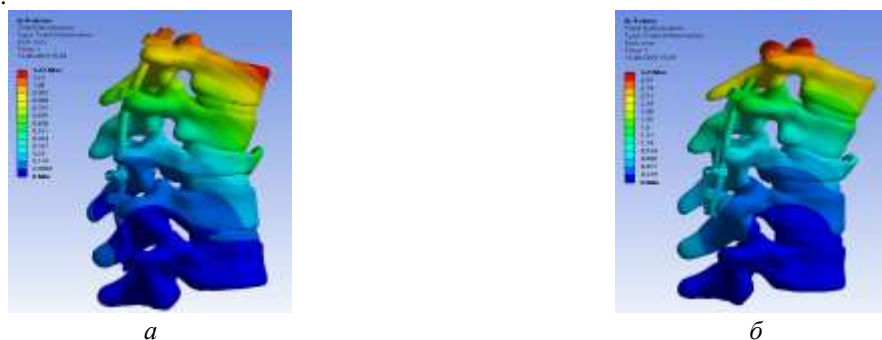
Рисунок 4 – Поля полных перемещений для двух моделей при наклоне: a – фиксация 8 винтами, б – фиксация 4 винтами
