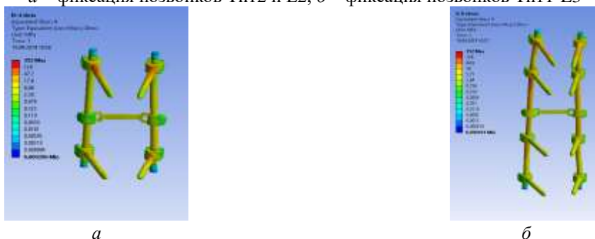
Рисунок 6 – Поля эквивалентных напряжений для фиксирующей конструкции при наклоне: a – фиксация позвонков Th12 и L2, б – фиксация позвонков Th11-L3
