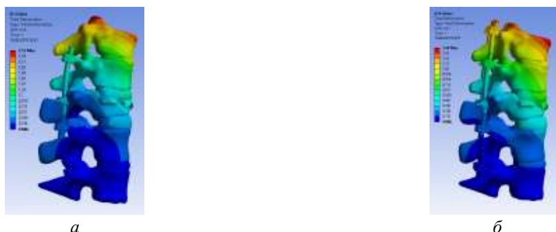
Рисунок 4 –Поля полных перемещений для двух моделей при наклоне: a – фиксация позвонков Th12 и L2, б – фиксация позвонков Th11-L3
