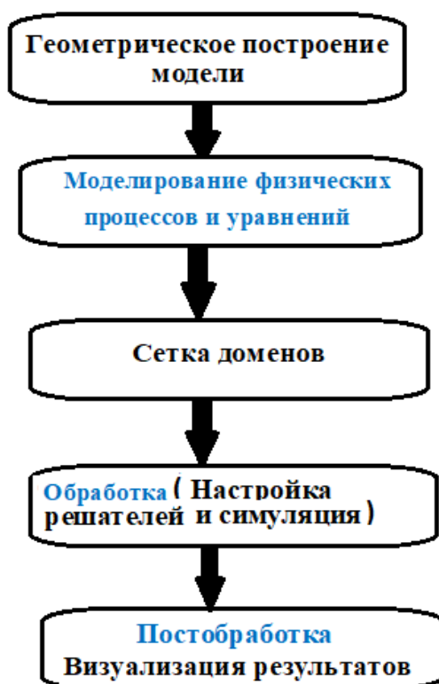
Рис.12. Базовая программная структура численного моделирования в COMSOL Multiphysics®.
