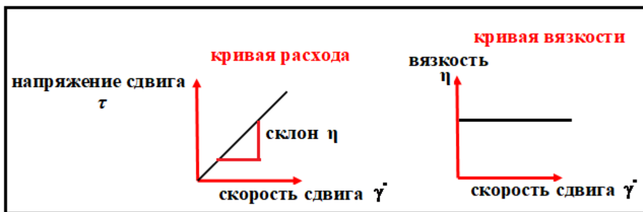
Рис.8. Кривая расхода и кривая вязкости для ньютоновских жидкостей.
