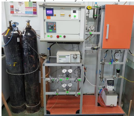
Рисунок 2. Установка, на которой процессы осуществлялись при давлении 6 атм Условия проведения процесса гидроочистки:
