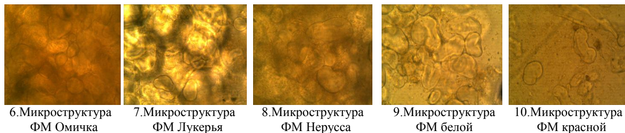
Микроструктура крахмальных зерен ФМ при нагреве до 80°C
