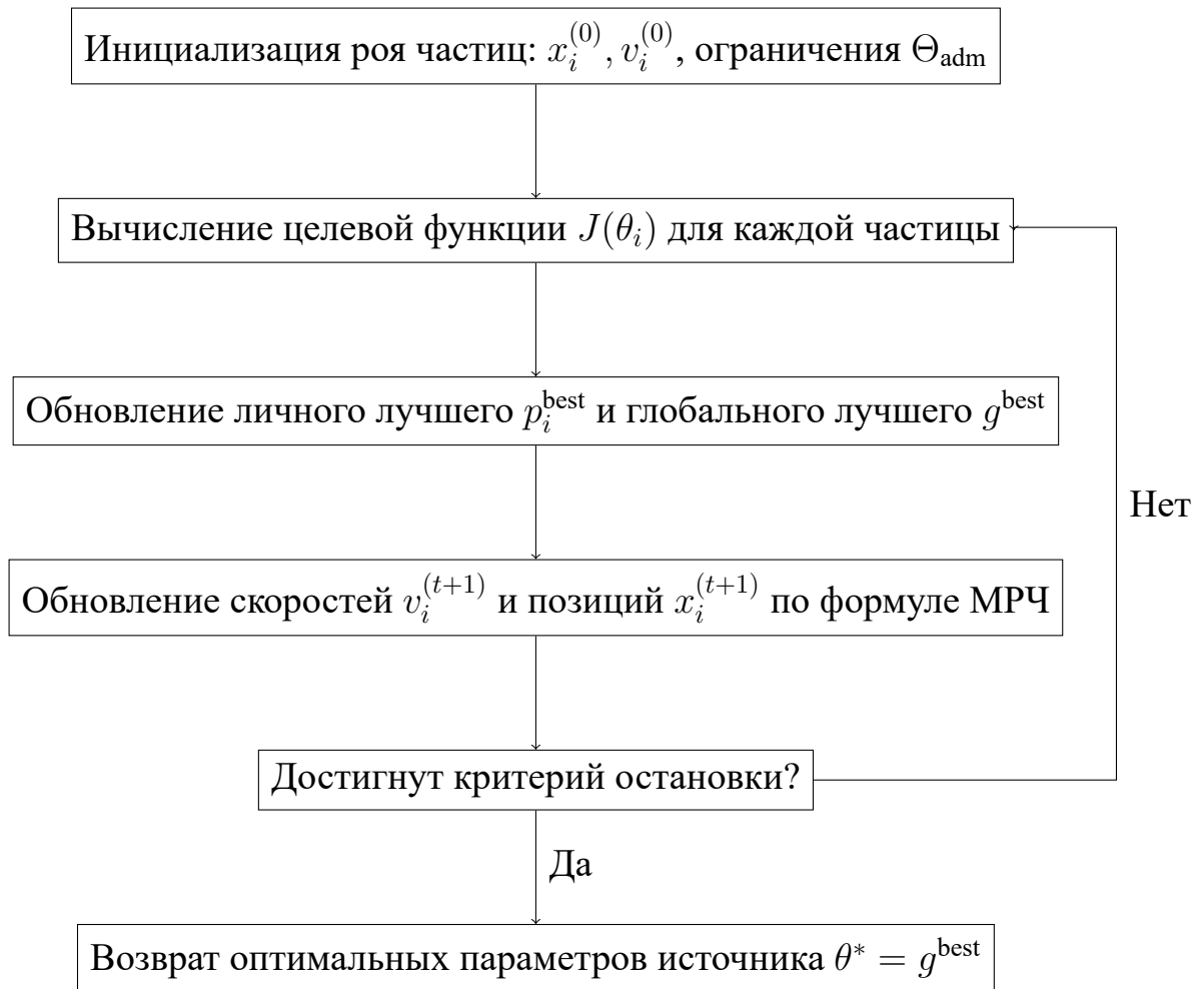
Рисунок 8 — Схема работы метода роя частиц для поиска параметров источника загрязнения
