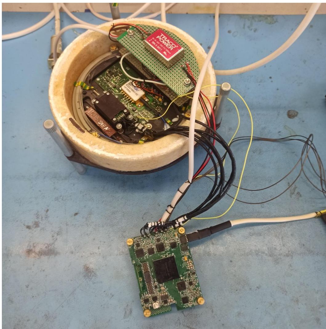
Рисунок 2.12 - Фотография лабораторного макета ВОГ с системой снижения шума. Общий вид
