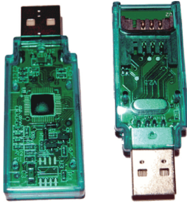
Рис. 3. Флеш-память на основе МДП-транзисторов с плавающим затвором
