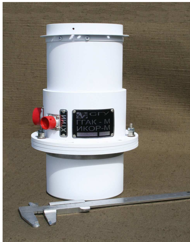
Рис. 1.1 Внешний вид радиометра ИКОР-М
