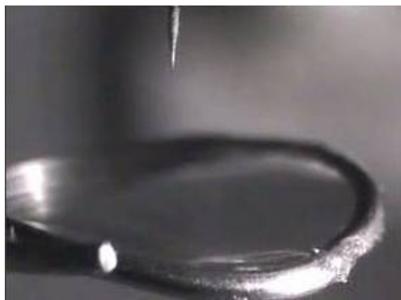
Рис. 4-24. Изображение в оптическом микроскопе УТИ кольца и кончика зонда
