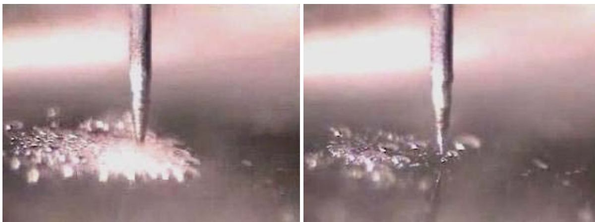
Рис. 4-27. Процесс «кипения» при протекании электрического тока между поверхностью щелочи и зондом (слева) и момент прекращения «кипения» при перетравливании кончика зонда (справа)
