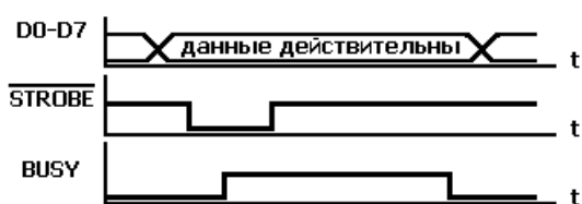
Рис. 8. Временная диаграмма сигналов обмена данными по упрощенному протоколу Centronics
