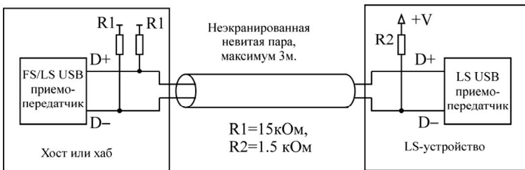
Рис. 13.7. Кабель низкоскоростного (LS) устройства и подсоединение резисторов
