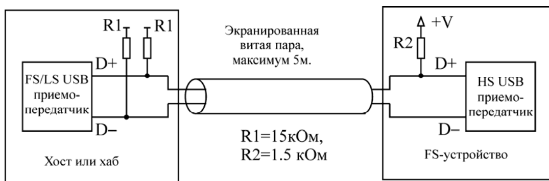
Рис. 13.8. Кабель полноскоростного (FS) устройства и подсоединение резисторов
