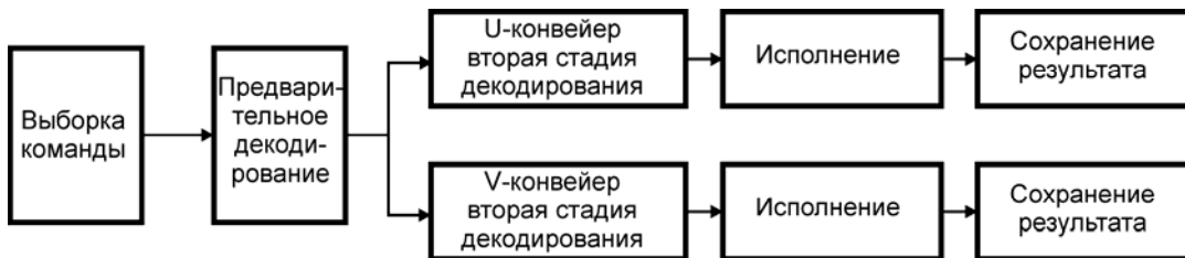
Рис. 12.2. Конвейер в процессоре Pentium
