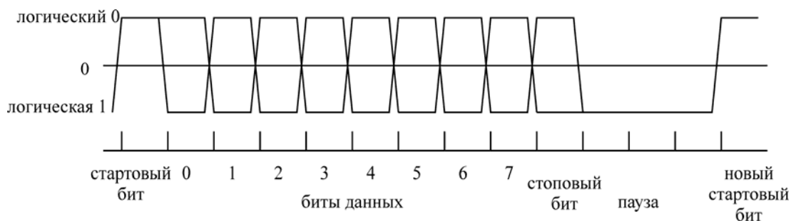
Рис. 13.4. Временная диаграмма передачи байта в COM-интерфейсе
