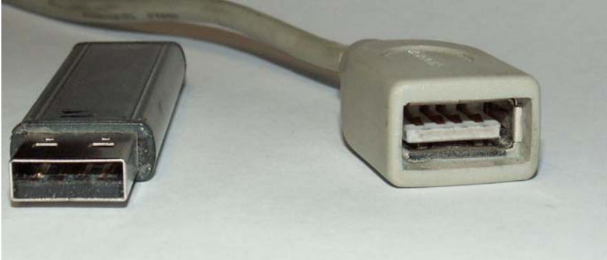
Рис. 13.6. USB-разъемы на флэш-карте и USB-удлинителе
